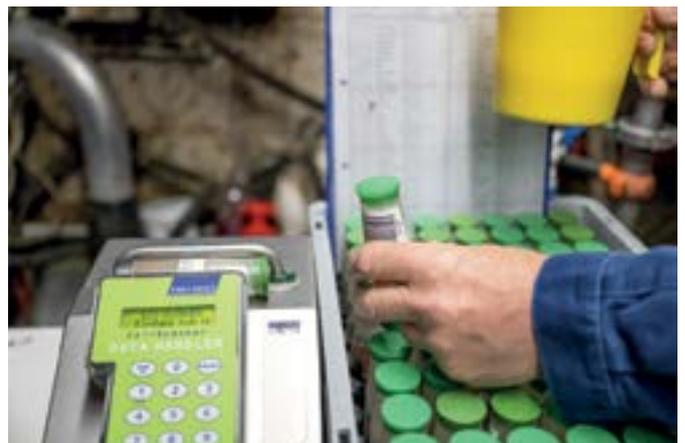
*Registrierung der Milchmenge und der Milchprobe mit dem Ezi-Scanner und dem Data-Handler*
