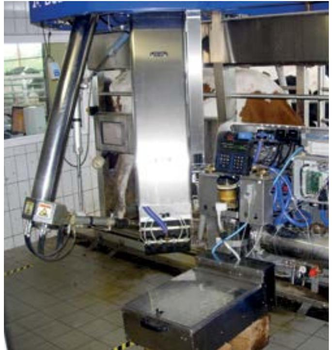
Probenahme in einem Melkroboter bei der Milchkontrolle
