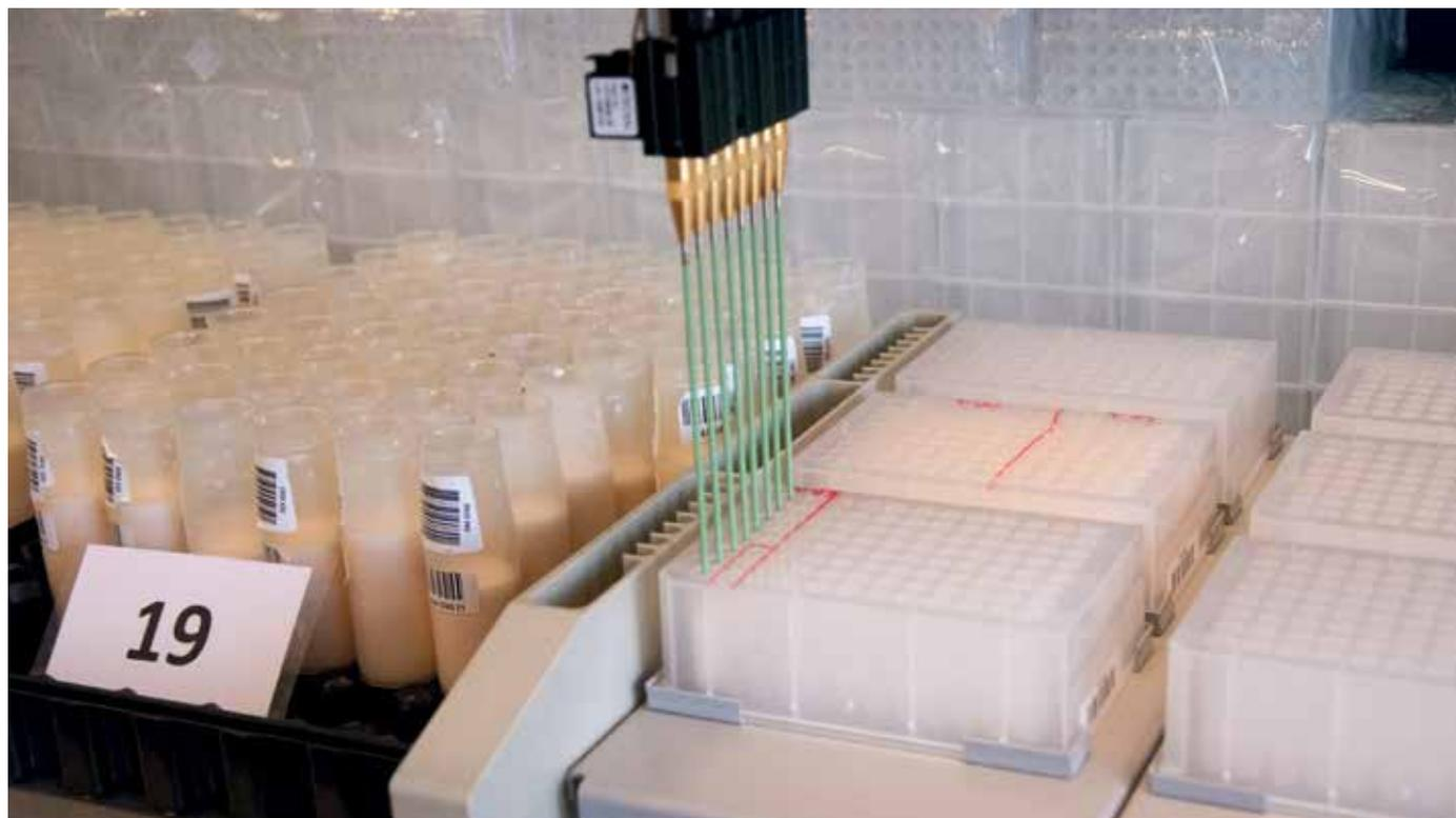
*Der Pipettier-Roboter bei der Arbeit*
